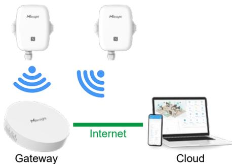
Zur Übertragung der Messwerte verwendet der Raumklima-Sensor den LoRaWAN Standard. Die Daten werden so kabellos an ein separat erhältliches Gateway übertragen, welches dann über Internet die Daten in einer Cloud speichert. So sind die Daten mit Statistiken von überall für Sie abrufbar.
